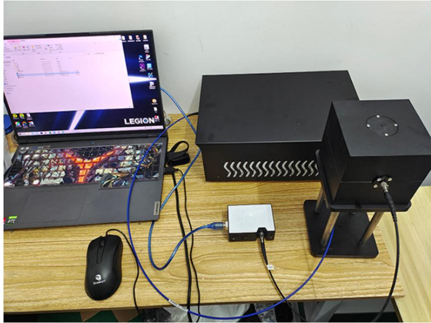
积分球(Integrating sphere)又称光通球、光度球，是一个完整的空心球壳。积分球多由金属材料制成，内壁上涂有白色的高漫反射层(通常为氧化镁或硫酸钡)，球壁上开一个或几个窗孔，用作进光孔和放置光接收器件的接收孔。积分球的内壁应是良好的球面，通常要求它相对于理想球面的偏差应不大于内径的0.2%积分球内部的氧化镁涂层在可见光谱范围内的光谱反射比都在99%以上，这样，进入积分球的光经过内壁涂层多次反射，在内壁上形成均匀照度。为获得较高的测量准确度，积分球的开孔比应尽可能小。开孔比定义为积分球开孔处的球面积与整个球内壁面积之比。
