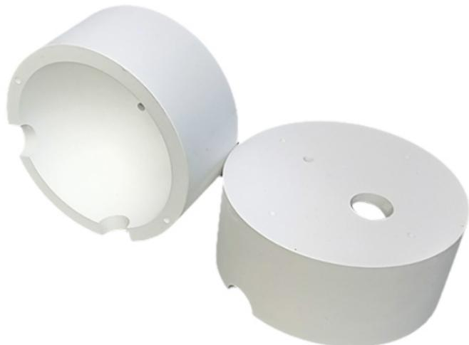
积分球的选购要注意什么？积分球开孔的位置和大小：要根据实际测量需要考虑，一般的讲：要按照设计的光路来确定积分球开孔的位置，应有利于光路调整和固定；开孔的大小要满足光斑以及接收器的使用条件。在样品孔和接收器之间加隔板：在输入光束与出光孔之间，通常需要加一个挡屏，积分球隔板的作用就是防止光源的一次光进入接收器，以提高测量的精确度。有时还要考虑一些其它的配件：如孔塞，积分球开口不使用时，用孔塞堵上；如光阱，是圆柱形空腔，内涂以有强吸收的黑色涂料，用以收集样品的镜面反射成分；如积分球配接器，用以连接其它设备等。山东光通球内胆定制积分球主要用于测量发散光源的光功率、通量、反射率和辐射剂量等参量。
